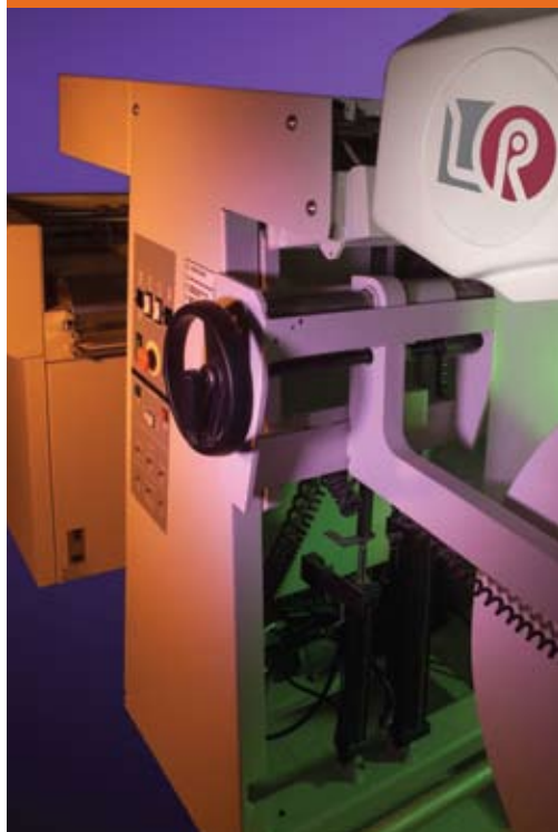
Der DocuSheeter VP 5000 arbeitet zusammen mit dem Océ VarioPrint 5000-Digitaldrucker und besteht aus einem Abroller, Schneider und einem Blatttransport.
